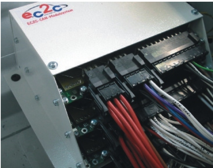
Drei »EC2C-E-/A«-Module in einem Gehäuse. Der Dauerstrom aller 24 Ausgänge kann hier 288 A betragen.
