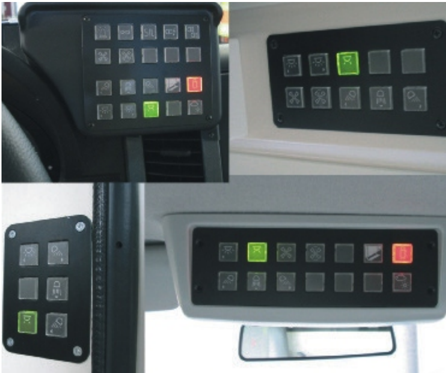
Die bisherige »EC2C«-Tastatur-Familie. Rechts unten sieht man die Ausführung für den DIN-Schacht, die im oberen Bereich des Cockpits eingebaut wurde.
