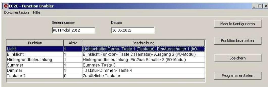
So sieht ein einfacher Parametrierungsrahmen aus. Der Anwender wählt in der Aktiv- Spalte die gewünschten Funktionen aus und überträgt das erstellte Programm zum EC2C-Master. Mit einem Mausklick ist der Rahmen zusätzlich abgespeichert und kann jederzeit wieder geladen werden.
