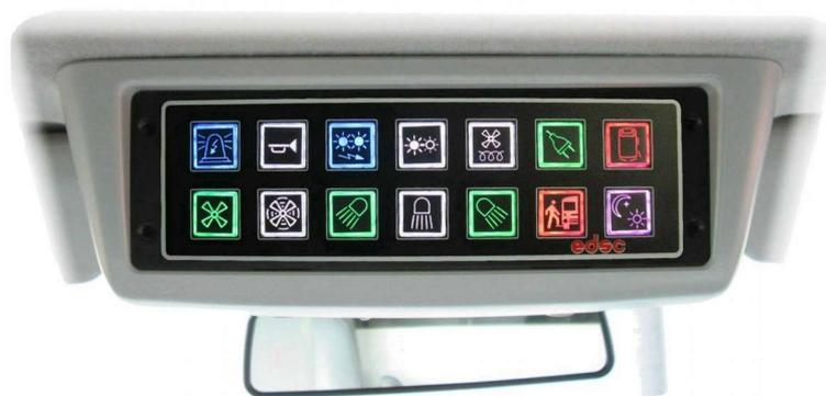
EC2C-14er-Tastatur für den DIN-Schacht, die über dem Rückspiegel im oberen Bereich des Cockpits eingebaut wurde.
